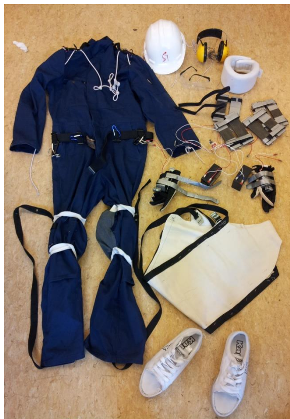
Figur 1. Eldresimulatoren Tidemand slik den var brukt under brukertestene. Fra venstre og ned: dress med innebygde strikk, stropper og sandsekker, hjelm, hørselsvern, briller, nakkekrage, vekter til armene, motoriserte hansker med batteri, hoftebeltet og sko.
